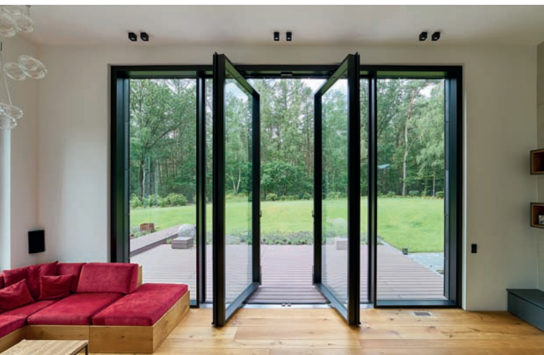
Spektakuläre Abmessungen: 6,05 x 4,20 Meter misst das dreifach verglaste Fassadenelement mit einem U-Wert von 1,15 W/m 2 K (Schüco Stahlssysteme Jansen VISS 50). Alle Fotos: Schüco International KG / Andreas Weiss, Hamburg
