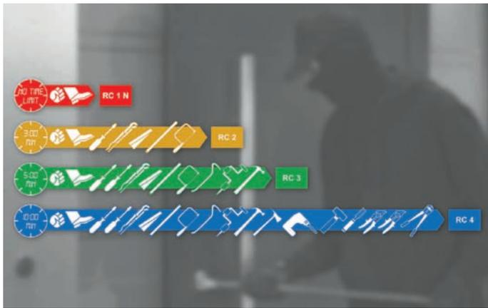
Die Widerstandsklassen geben Standards vor, die wiederum von unabhängigen Prüfinstituten getestet werden. So muss beispielsweise eine Haustür der Widerstandsklasse RC 2 einem Einbruchversuch mit einfachen Werkzeugen mindestens drei Minuten standhalten. Es empfiehlt sich jedoch die Sicherheitsausstattung RC 3. Einem Einbruchversuch mit einfachem Werkzeug hält die Tür dann mindestens fünf Minuten stand. Quelle: [www.hoermann.de](http://www.hoermann.de)
