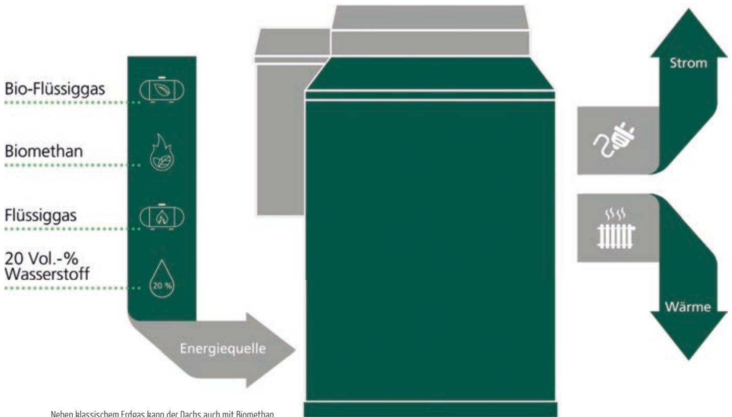
Neben klassischem Erdgas kann der Dachs auch mit Biomethan, (Bio-)Flüssiggas und bis zu 20 Volumenprozent Wasserstoff betrieben werden. Flüssiggas ist eine etablierte Alternative zum Erdgas. (QUELLE: SenerTec)
