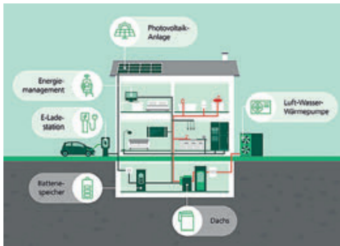
Abbildung 3: Dachs-Heizungsanlage mit Batteriespeicher, Wärmepumpe und PV-Anlage. Im Winter liefert der Dachs Strom für die Batterie & Wärmepumpe wohingegen im Sommer die PV-Anlage den Strom liefert
